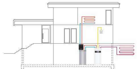
Wärmepumpen und Photovoltaik sind kein Widerspruch. Während die Solaranlage im Sommer das warme Wasser erzeugt, kann die Wärmepumpe zusammen mit der Passiven Kühlstation für angenehme Raumtemperaturen sorgen.
